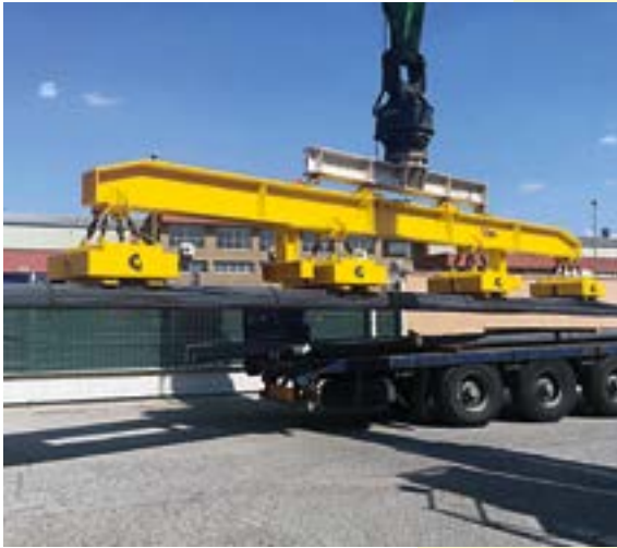
Traversa con elettromagneti a campo profondo per fasci 6-12 m, 7 t, montata su semovente
