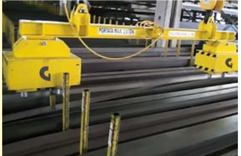
Traversa con elettromagneti a campo profondo con poli mobili
