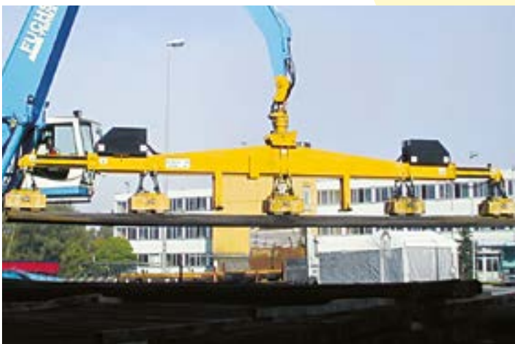
Traversa estensibile idraulicamente con elettromagneti per fasci tondino 12-16 m, 5 t, montata su semovente
