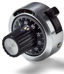
**Einstellknopf MKT im Ø31 mm Gehäuse mit 100er Stricheinteilung, Umdrehungszähler (3 bis 10 Udr.) und Feststellbremse**
