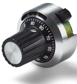
**Einstellknopf SKT im Ø26 mm Gehäuse mit 50er Stricheinteilung, Umdrehungszähler (bis 10 Udr.) und Feststellbremse**
