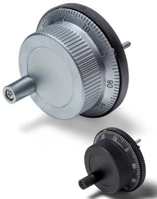
Die Handräder der Serie MHU haben eine Auflösung von 100 (optional 25) Impulsen pro Umdrehung und ermöglichen durch die feinfühligte Rastung mit 100 hör- und fühlbaren Klicks ein sehr sicheres taktiles Handling. Mit der Wahlmöglichkeit aus 4 elektrischen Ausgangsschaltungen ist die Kompatibilität zu vielen Applikationen gegeben.
